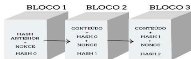
Figura 3: Criação de nonce por bloco - solução para o algoritmo PoW.
